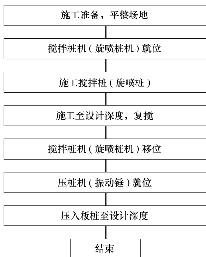
图 6.5.1 植桩法施工工序
